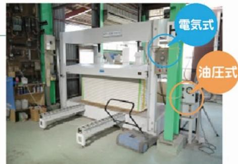
油圧の良さと電気の良さを合わせたハイブリッドプレスは小口小ロットが基本のトマト工業の理想的な設備なのです。
